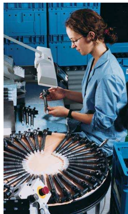
Sichtprüfung: eine Bosch-Mitarbeiterin überwacht die Qualität von Injektoren des Einspritzsystems CRS im Werk Bamberg. Fotos: Bosch
