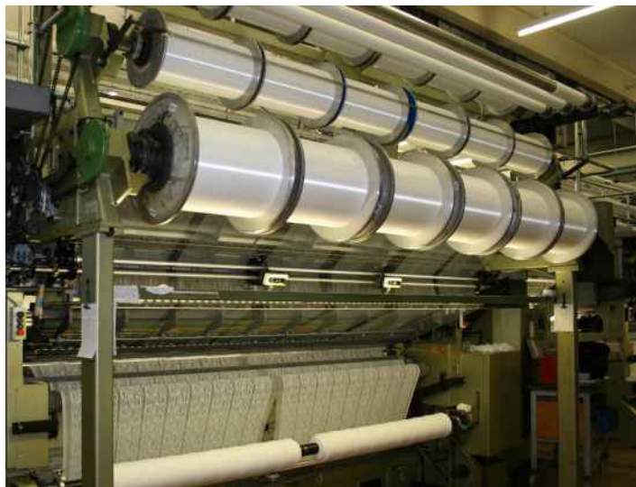
Feine Stoffe: Eine Raschelmachine zur Spitzenherstellung.
