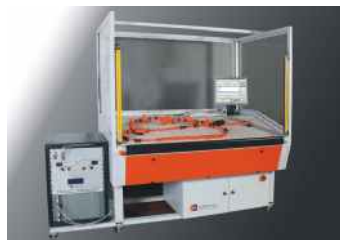
Hochspannungs-Prüftisch: Bei der Endprüfung von Leitungssätzen für Hybrid- und Elektroautos müssen bis zu 6.000 Volt Spannung und 25 Ampere Stromstärke bewältigt werden.
